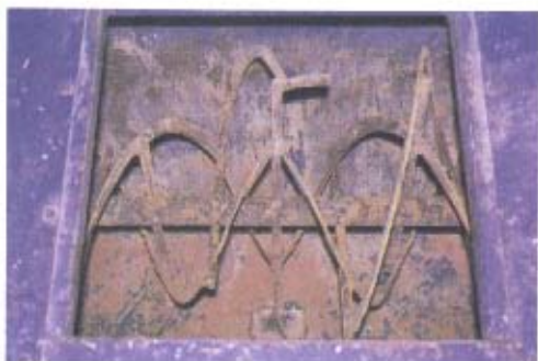
ภาพที่ 4 แสดงภายในของเครื่อง ผสมอาหารแบบแนวนอน
