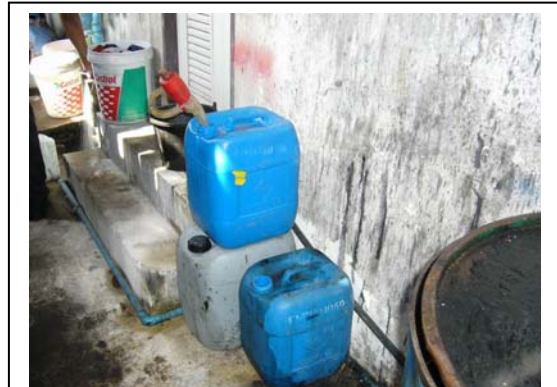
ภาพที่ 4 ภาพแสดงไม่มีการกั้นพื้นที่หรือถาดรองรับการหกรั่วไหลของน้ำมัน
