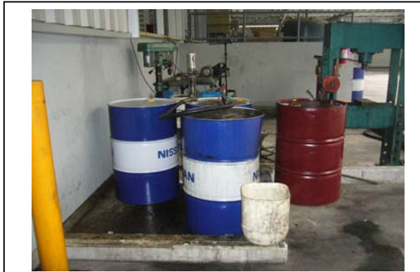
ภาพที่ 3 ภาพแสดงการกั้นพื้นที่เพื่อป้องกันและรองรับการหกรั่วไหลของน้ำมัน
