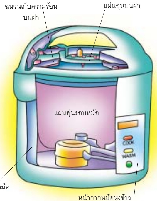
โครงสร้างภายในของระบบอุ่นแบบอัตโนมัติ
