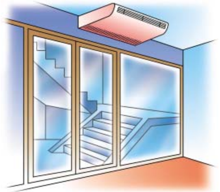
ทำผนังกันบริเวณช่องบันไดทางเดินผ่านระหว่างชั้น
