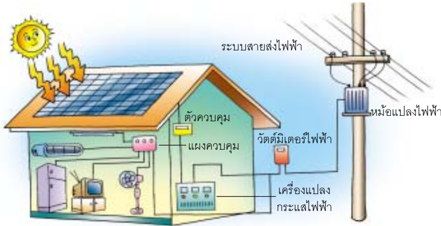
ระบบผลิตไฟฟ้าด้วยเซลล์แสงอาทิตย์เชื่อมต่อสายส่ง
