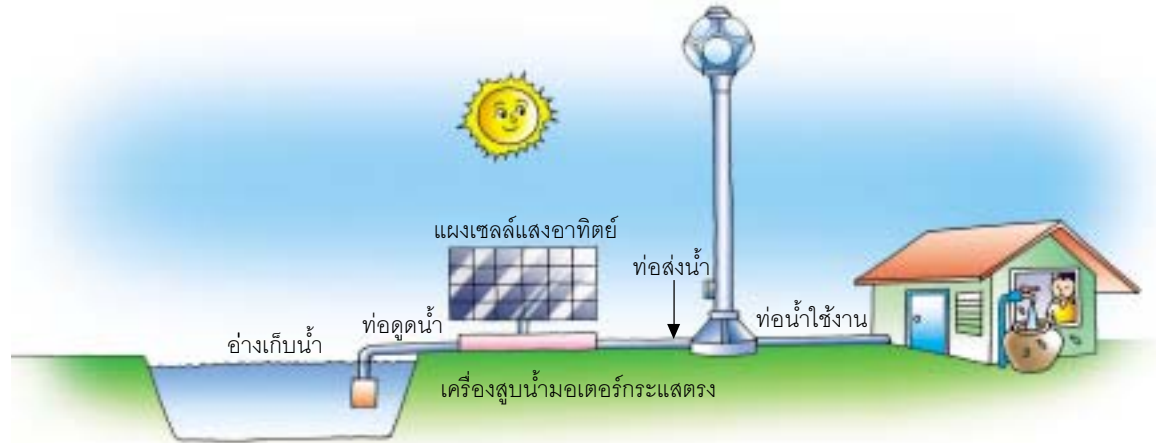
ระบบสูบน้ำด้วยไฟฟ้าจากเซลล์แสงอาทิตย์
