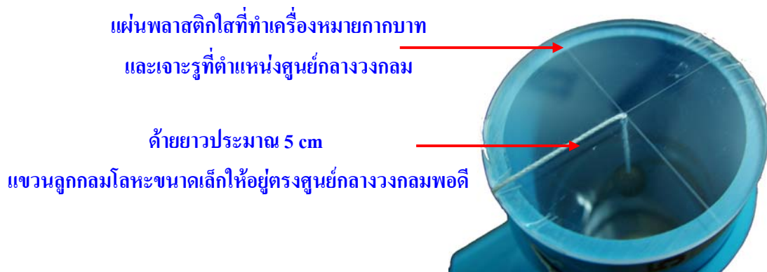
รูป 5 เคนซีโอมิเตอร์ มองจากด้านบน
