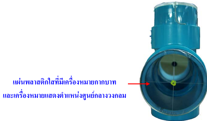
รูป 4 เคนซีโอมิเตอร์ มองจากด้านข้าง
